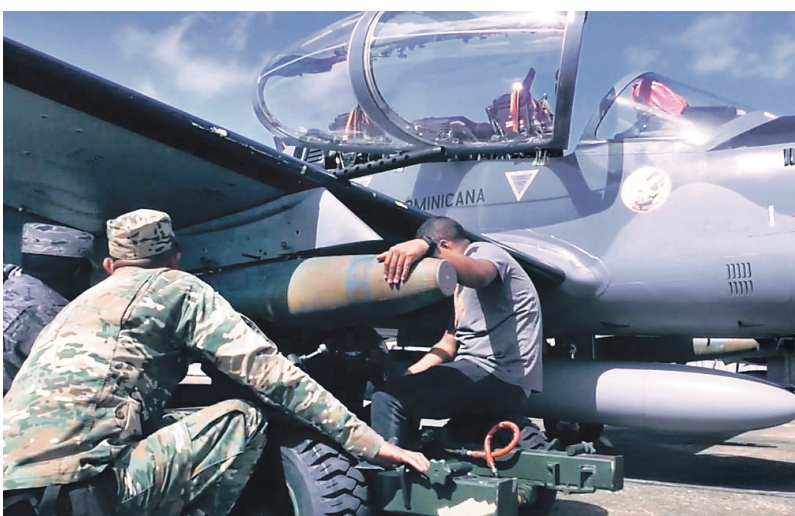
Soldados de la FARD (izq.) montan una bomba de 500 libras, sin explosivo, a un avión Súper Tucano. A la derecha, el cráter del impacto en tierra.
