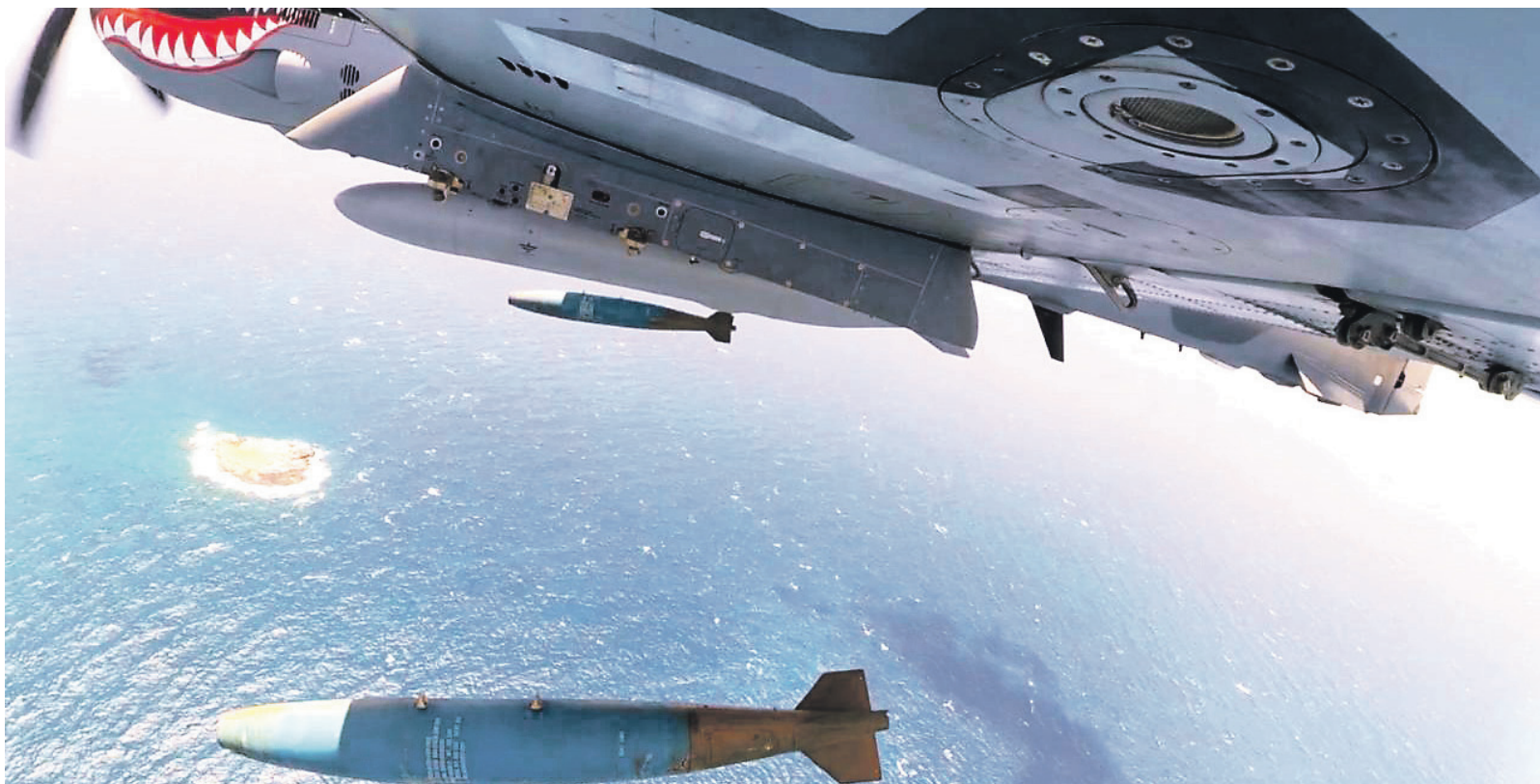
Momento del lanzamiento de una bomba de 500 libras, sin explosivo, desde un avión Súper Tucano, a un blanco sobre la superficie del agua.
